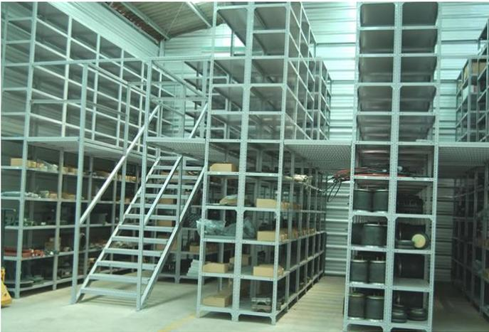
Utilizando elementos básicos podemos lograr el sistema eficiente y adecuado de almacenaje en dos niveles.
